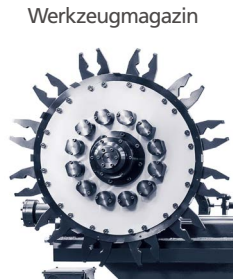
12 Werkzeugplätze: davon ist eins für das Ein- und Auswechseln freizuhalten
