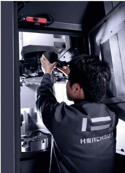
Die Bestückung des Revolvers erfolgt bequem von der Seite durch eine zweite Maschinentür (VT-650).
