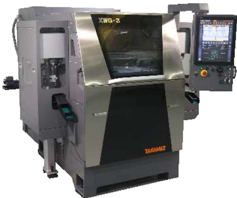
Die XWG 3 ist ausgestattet mit automatischem Loader, sowie je einem Teilzu- und Abführband. Besonders geeignet für die einfache Serienbearbeitung von vorgefertigten Schmiede- und Druckgussteilen sowie gesägten Rohlingen.
